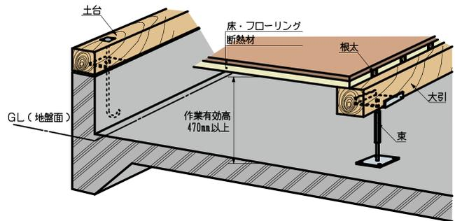
べた基礎とは、基礎の立ち上がりだけでなく、底板一面がコンクリートになっている基礎です。家の荷重を底板全体で受け止め、面で支えています。
